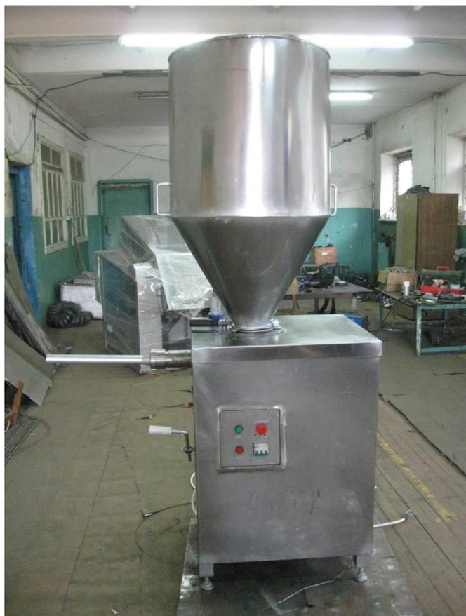
Шприц вакуумный ВШУ-1М предназначен для вакуумирования мясного фарша и наполнения колбасных оболочек при выполнении технологической операции производства вареных и полукопченых колбас, сосисок, сарделек.
