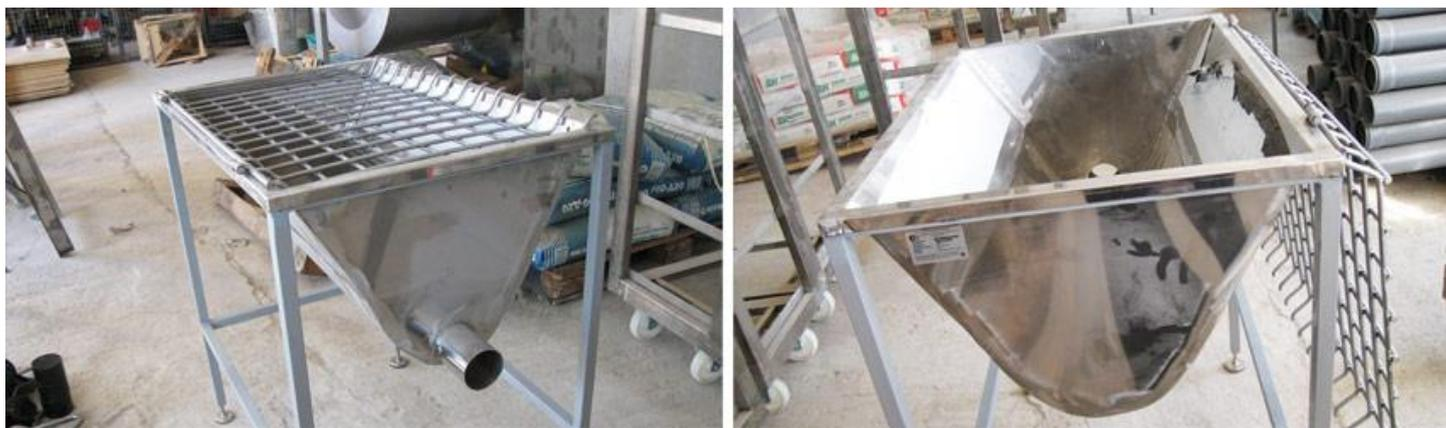
Стол СВЖ-15 предназначен для выполнения технологической операции по приёму, опорожнению и проверке желудков после нутровки скота. Представляет собой сварную раму, с расположенной внутри чашей-лотком (лист толщиной 1,5 мм) со сливом (труба Ø76 мм или по ТЗ заказчика для возможности подключения к внутрицеховым системам), расположенным под углом к горизонтальной плоскости. Также в днище лотка может быть вмонтирована форсунка для гидротранспортирования содержимого желудков.
