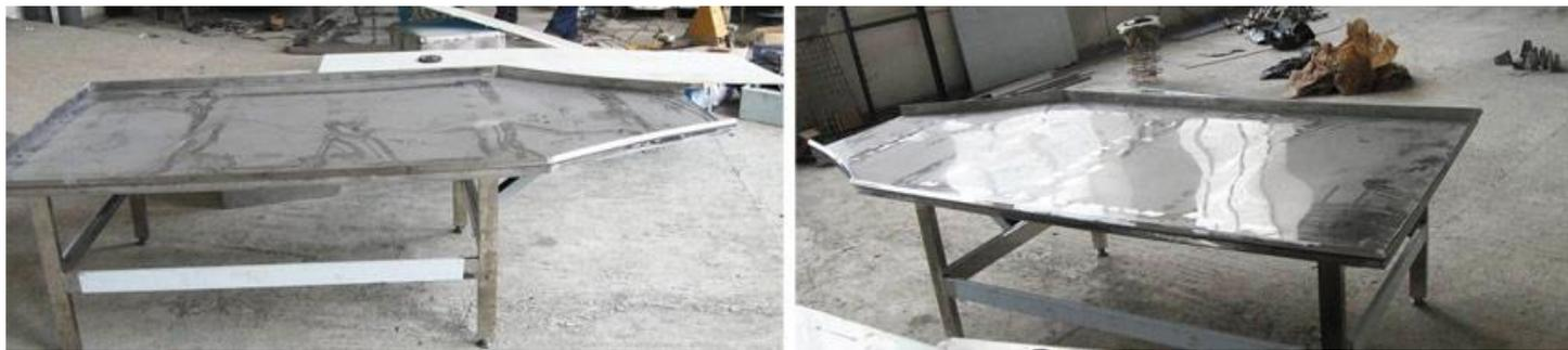
Стол формовочный предназначен для выполнения технологической операции по приёму колбасных батонов после шприца, ручной вязки, сортировки и укладки батонов. В случае клипсования на него возможна установка клипсатора. Является рабочим местом оператора вакуумного шприца и формовщика-сортировщика.
