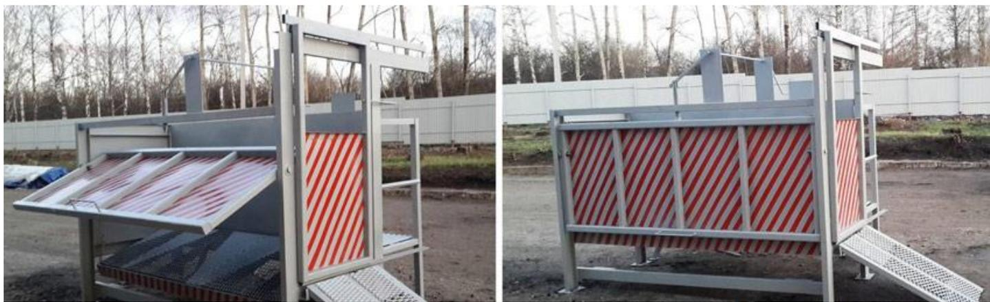
Бокс оглушения КРС саморазгружающийся — производительностью 10 голов в час. Представляет собой сварную конструкцию, состоящую из площадки бойца, непосредственно секции оглушения с поворотной стенкой, опрокидываемым днищем-склизом и откатной дверью.
