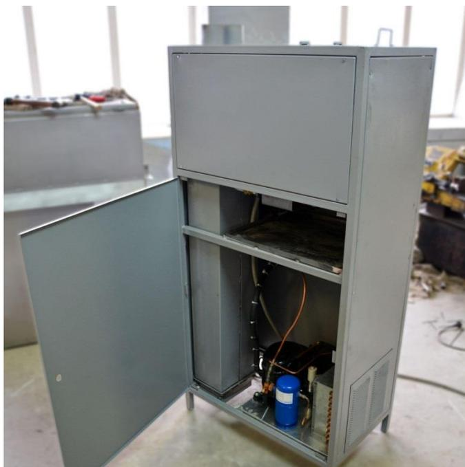
Охладитель дыма серии "ОДУ" предназначен для комплектования универсальных комплексов термодымовой обработки мясных и рыбных изделий функцией холодного копчения. Оборудование позволяет поддерживать оптимальный технологический режим термообработки. В качестве теплоносителя применяется "ледяная" вода, охлажденная во встроенном теплообменнике. Температура теплоносителя поддерживается автоматически. Комплектуется хладоагрегатом "Aspera".
