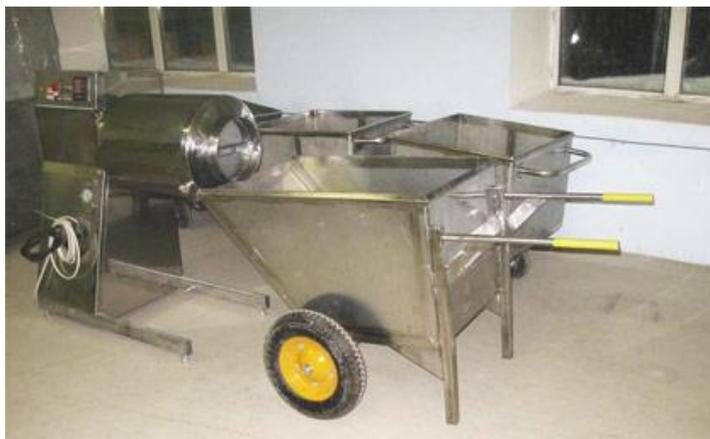
Мясомассажер МВУ-50М/70М/80М, предназначен для массирования мясного сырья, в разряженной емкости с рассолом, для улучшения потребительских свойств и увеличения выхода готового продукта. Применяется в технологической операции посола при производстве колбас и деликатесов.
