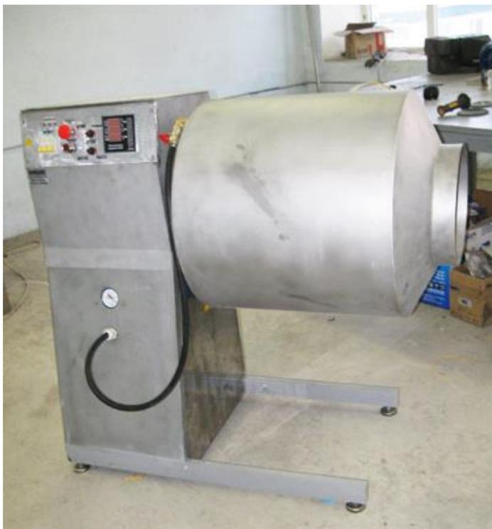
Мясомассажер МВУ-100.1 (100.2) исполнение 1 ёмкость / 2 ёмкости (опция-регулировка оборотов) предназначен для массирования мясного кускового сырья после инъектирования. Применяется в технологической операции посола при производстве колбас и деликатесов. За счёт использования в процессе глубокого вакуума оборудование позволяет значительно ускорить операцию посола, вместе с тем улучшить органолептические, физические показатели сырья и увеличить выход готовой продукции.
