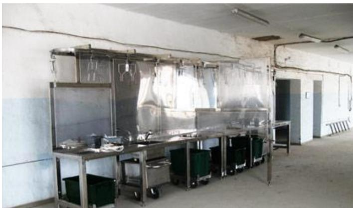
Линия ЛЗК-100 предназначена для обеспечения выполнения технологической операции по первичной переработке тушек кролика и птицы на предприятиях и в хозяйствах, занимающихся выращиванием и переработкой мяса кролика и птицы малой, средней и большой мощности. Идеально подходит для размещения в убойных цехах крестьянско-фермерских хозяйств. Конструктивные решения позволяют разместить и скомпоновать оборудование в любой конфигурации с учётом планировки помещения и разработанной технологической схемы.
