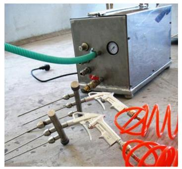
Инъектор ручной на 2 поста (ИР-2) предназначен для осуществления посола мясного, кускового сырья, птицы рыбы, путем введения рассольных растворов методом внутритканевой инжекции под давлением через иглы.
