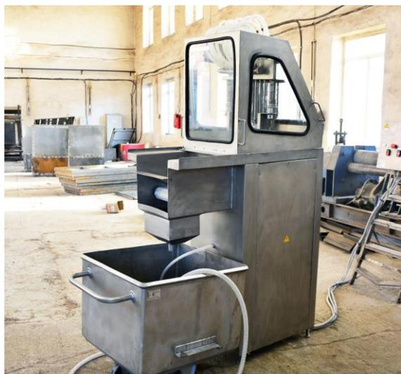
Автоматический инъектор ИПА-15 предназначен для посола способом инъекции рассольных и сложных растворов в кусковое мясное и рыбное сырьё при производстве колбас, деликатесов и прочего перед массированием и дозреванием. При использовании инъектора значительно увеличивается выход готовой продукции, ускоряется и улучшается качество посола сырья, а так-же значительно возрастают значения органолептических показателей и устойчивость к микробиологическим процессам.
